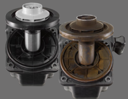
Magnetit- und Schlammablagerungen auf einer Heizungspumpe.
